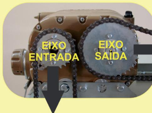
No eixo de entrada, a rotação é movida pelo rodado do implemento. É proporcional a velocidade de deslocamento.
