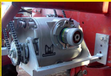
Para fazer a instalação, basta substituir o sistema de engrenagens e posicionar a caixa em local que tenha acesso aos eixos dos distribuidores e do rodado
