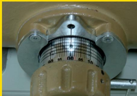
Manípulo que permite regular a quantidade exata de fertilizante a ser depositado
